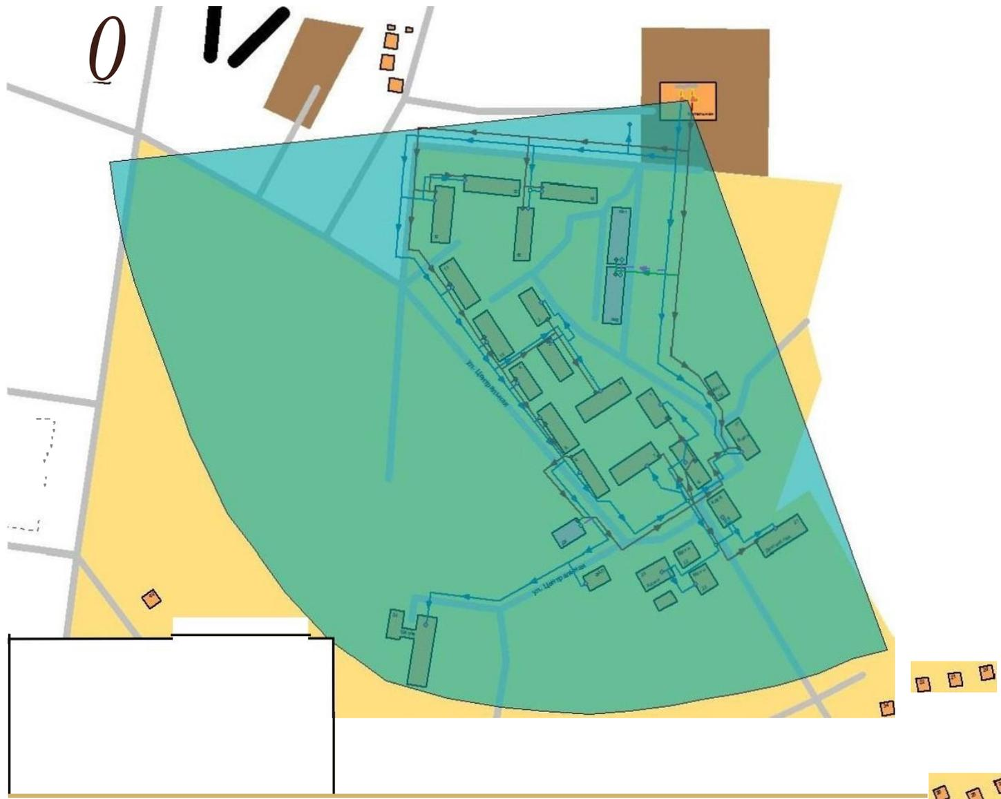
Рисунок 18. Зона действия и результаты расчета эффективности теплоснабжения котельной
