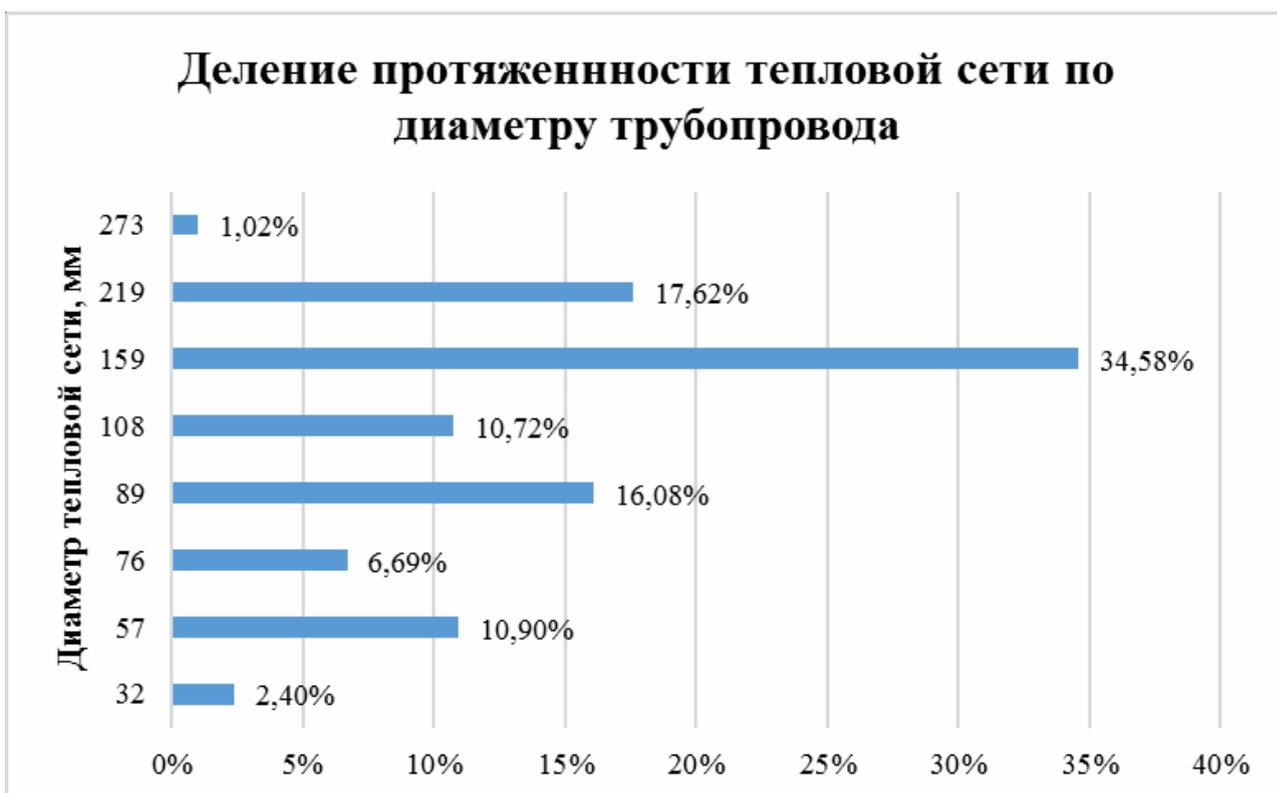
**Рисунок 6. Деление протяженности тепловой сети по диаметру трубопроводов**
