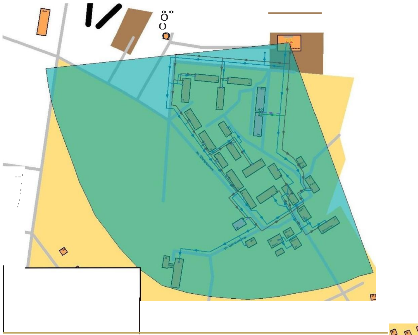
Рисунок 3.Радиус эффективного теплоснабжения от котельной
