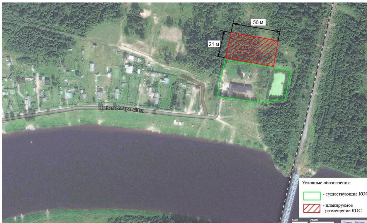
**Рисунок 25 - Предварительный план размещения площадки под строительство новых КОС**
