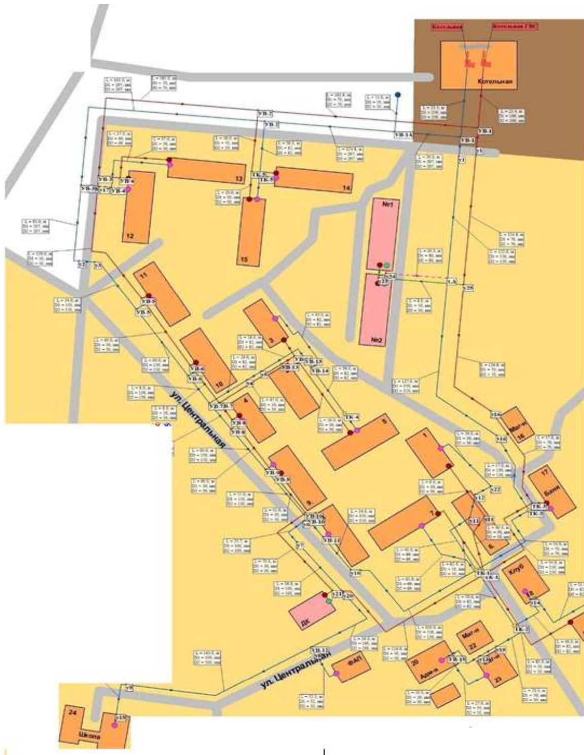
Рисунок 3 - Схема тепловых сетей к перспективному периоду
